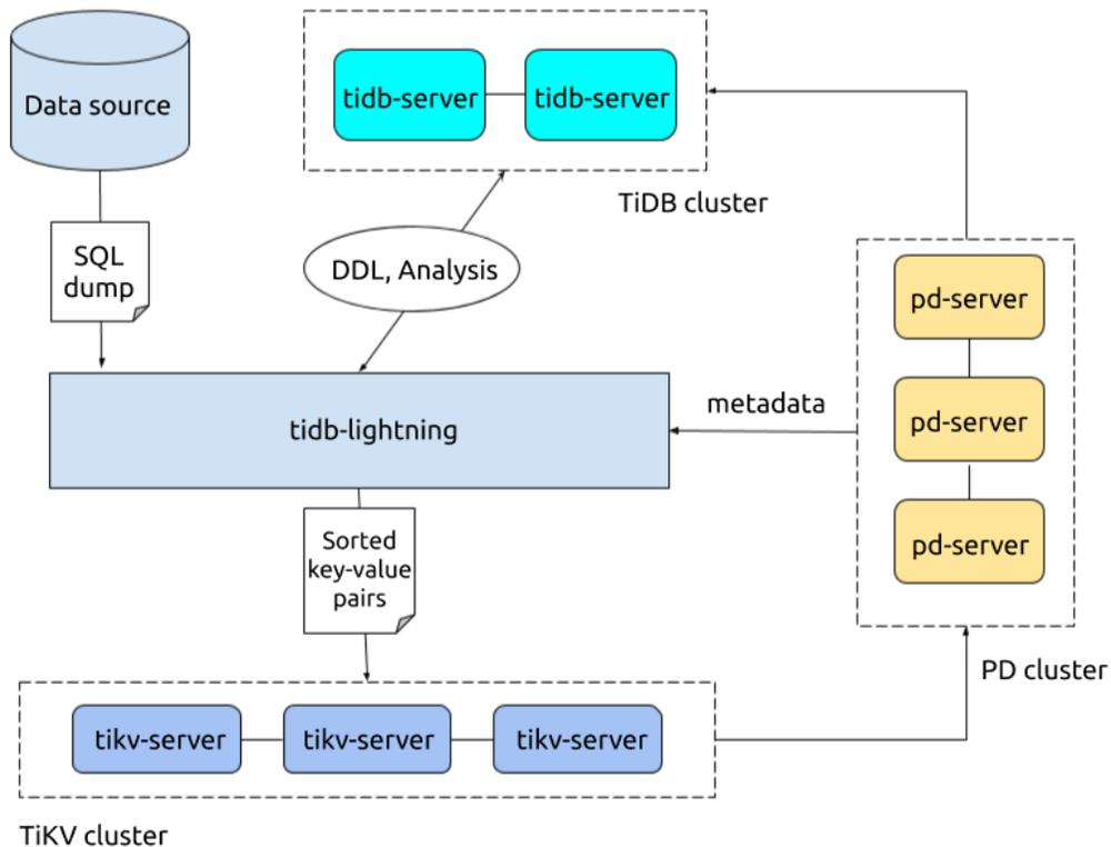
图 264: TiDB Lightning 整体架构
