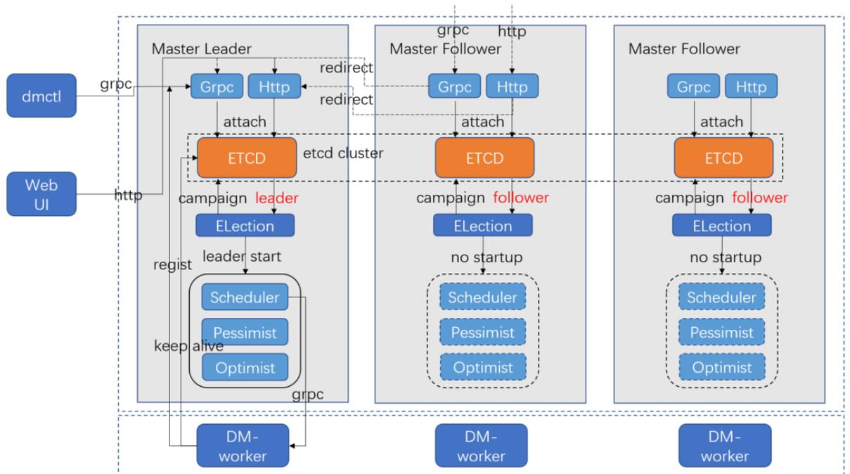
图 262: DM master 高可用架构
