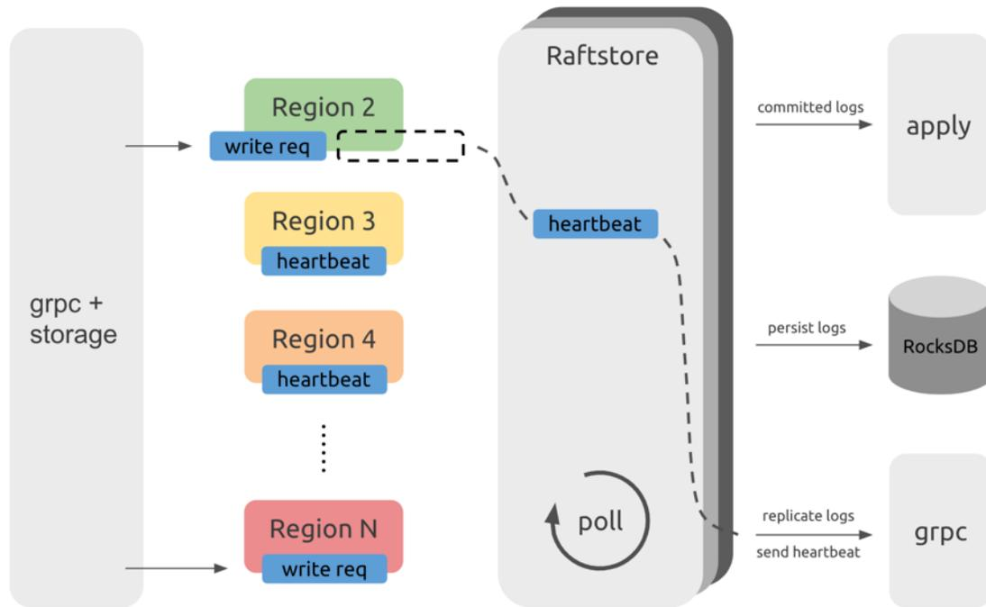
图 227: 图 1 Raftstore 处理流程示意图
